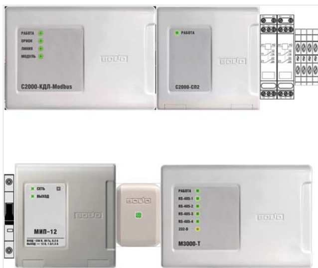
Рис. 9. Компоновка модуля помещения офисного комплекса
