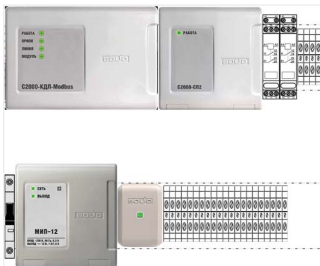
Рис. 10. Компоновка модуля помещения офисного комплекса. Исполнение 1
