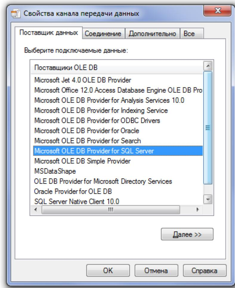
Во вкладке «Поставщик данных» следует выбрать строку «Microsoft OLE DB Provider for SQL server» и нажать кнопку **Далее >>**, произойдет перемещение на вкладку «Соединение».
