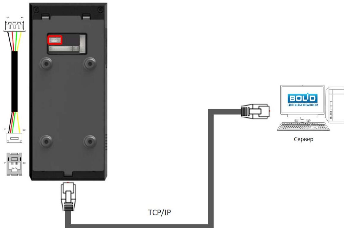
**Рисунок 7.** Подключение контроллера к ПК напрямую
