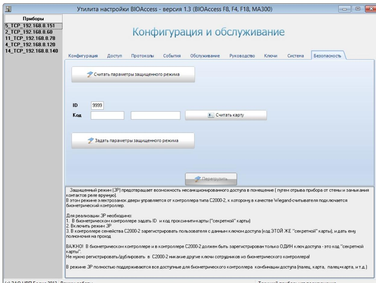
Кнопка «Считать параметры защищенного режима» позволяет принудительно считать из прибора и отобразить текущие настройки ЗР.
