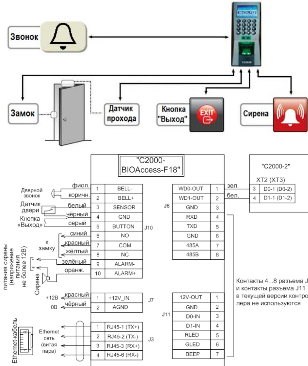
Рисунок 4. Схема подключений к контроллеру
