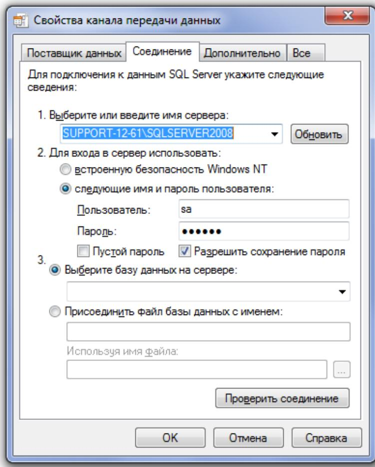
Следует выбрать имя SQL-сервера из выпадающего списка или ввести вручную. Ввести имя пользователя и пароль администратора сервера «Орион-Про». Рекомендуется поставить галочку  Разрешить сохранение пароля . После этого следует нажать кнопку **Проверить соединение**. При успешном соединении система выдаст следующее сообщение:
