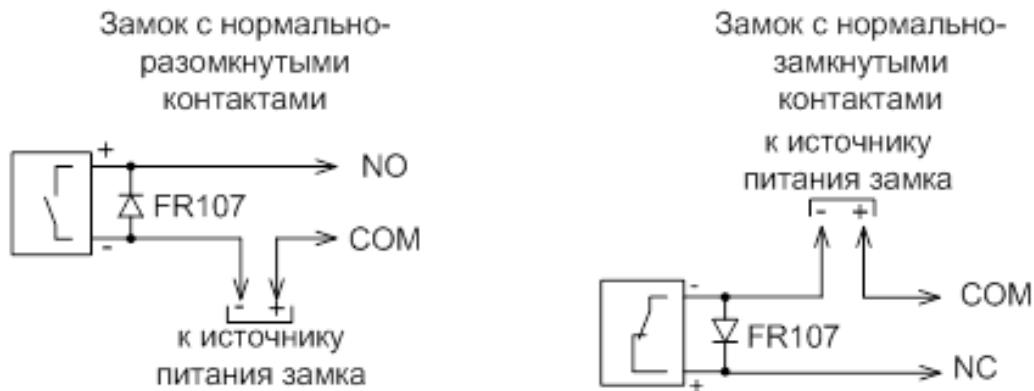
**Рисунок 5.** Рекомендуемые схемы подключения замков (разъём J10)
