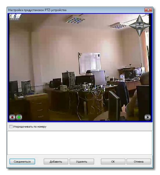
Для проверки работы устройства поворота и его настройки необходимо соединиться с камерой и получить видеопоток. Это можно сделать, нажав кнопку «Соединиться».
