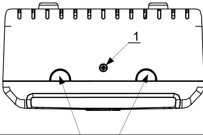
Нажать на выемки основания крышки для открытия крышки
