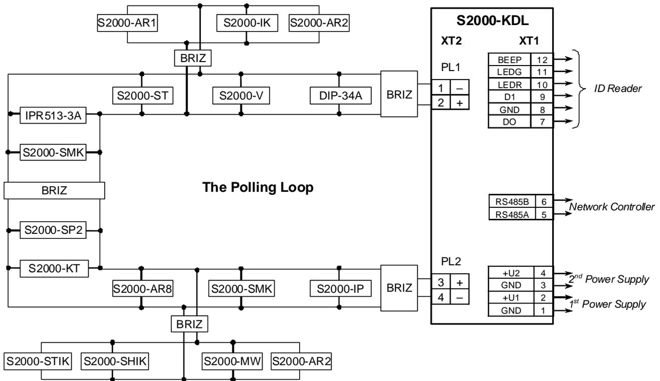
**Figure 4. S2000-KDL Wiring Diagram**
