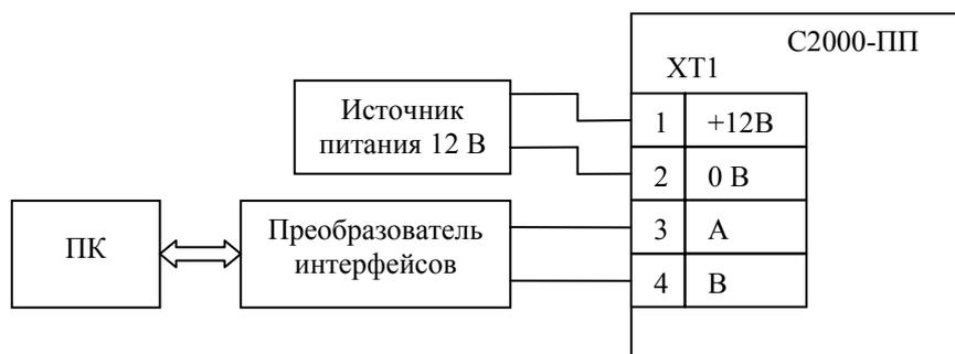
**Рисунок 8.** Схема для конфигурирования «С2000-ПП»
