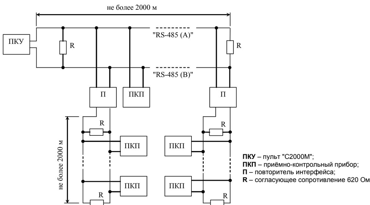
**Рисунок 4** Построение конфигурации "звезда" при помощи повторителей интерфейса
