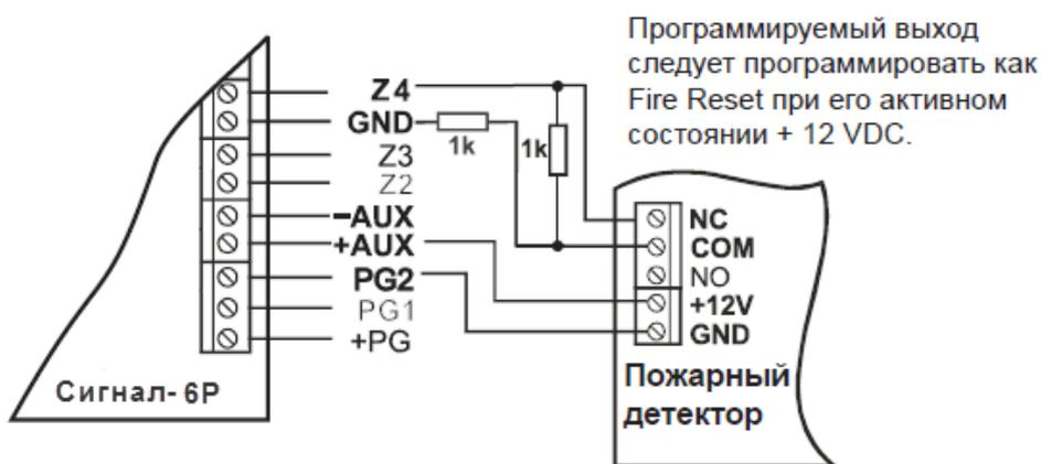
**Рисунок 15.** Соединение с клеммами прибора пожарных извещателей с 2-мя оконечными резисторами
