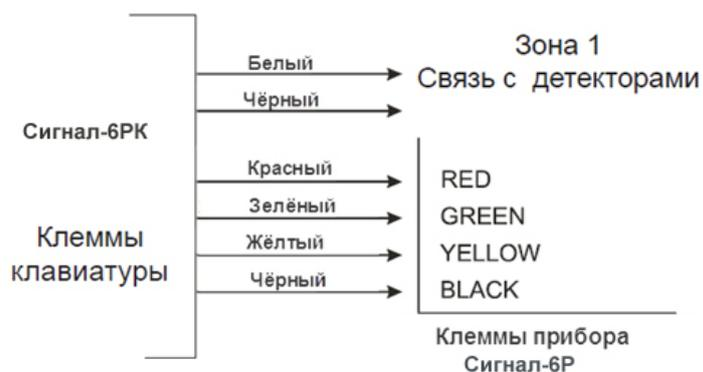
Рисунок 17. Схема подключения клавиатуры к прибору «Сигнал-6Р»
