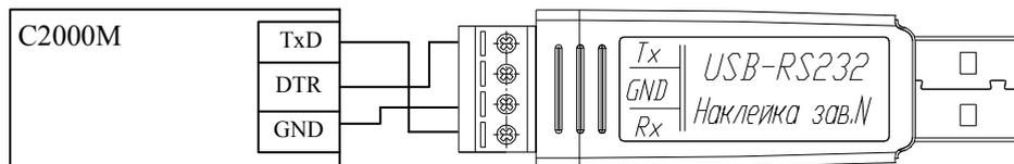
Рисунок 1 Схема подключения «USB-RS232» к пульту «С2000М»
