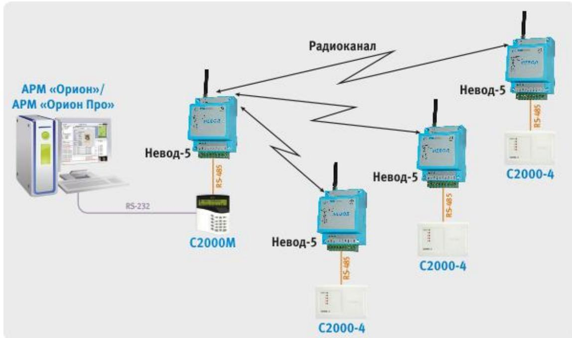
Конфигурирование модемов выполнялось в терминальной программе по RS-232.
