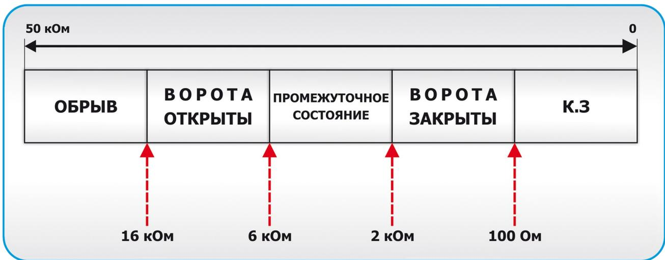
Рис. 5. Пороговые значения сопротивлений для контроля состояния ворот
