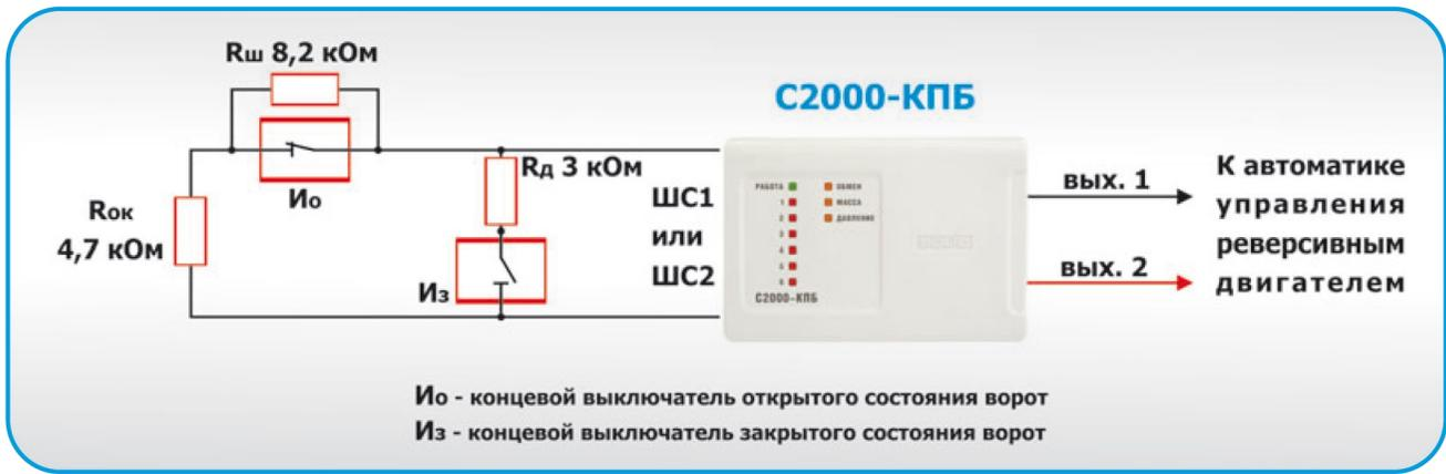
Рис. 4. Управление воротами с помощью C2000-KPB
