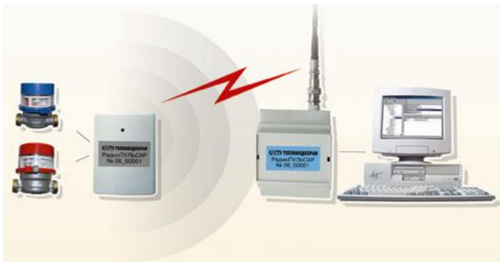
Рисунок 1 - Принцип работы Пульсар 16PM
