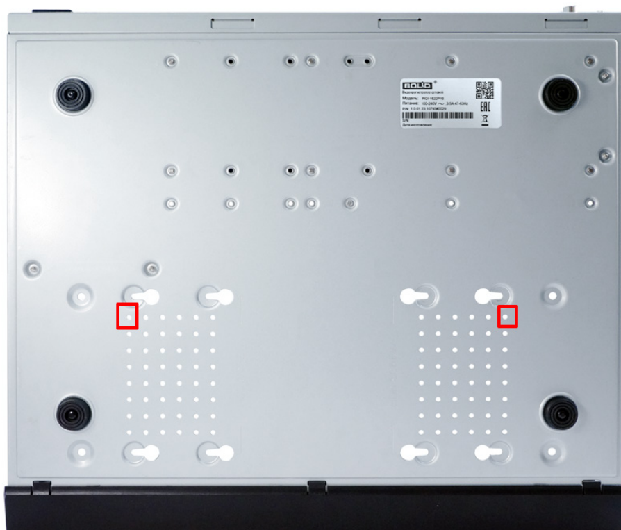
Рисунок 5.2 – Монтаж. Тип А
