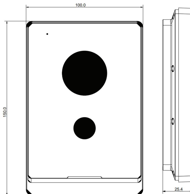
Рисунок 4.1 – Габаритные размеры
