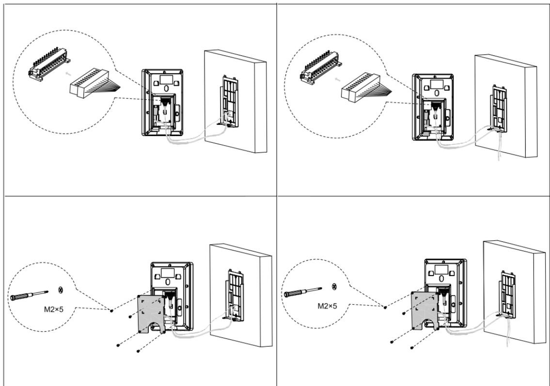
Рисунок 4.7 – Схема установки
