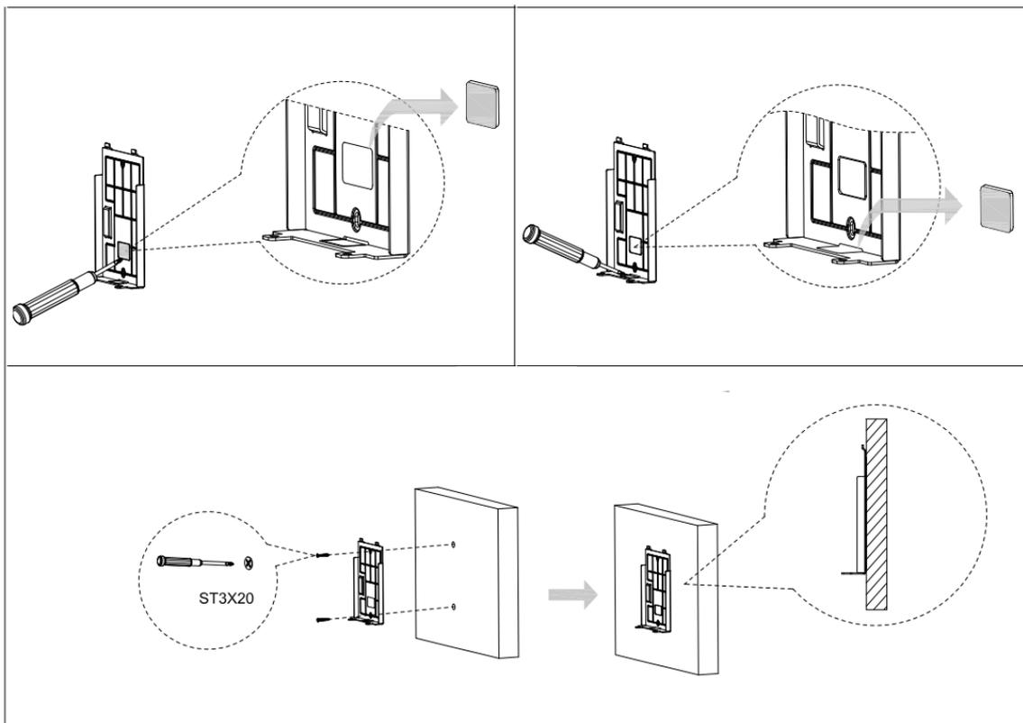
Рисунок 4.6 – Схема установки
