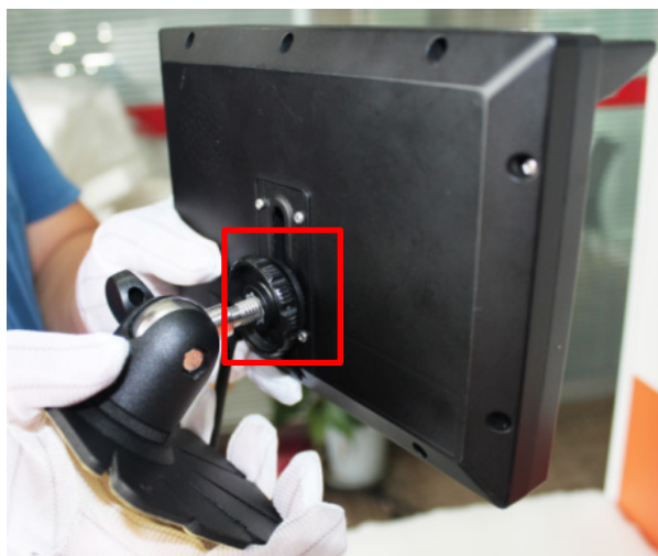
Рисунок 4.5 – Крепление монитора к кронштейну
