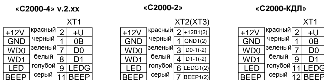
Рисунок 3. Схемы подключения к ПКП и контроллерам СКД (контроллер всегда слева)
