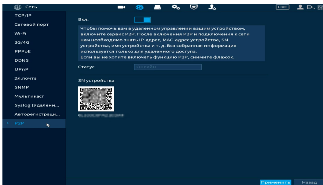
Рисунок 12.15 – Интерфейс включения «P2P»
