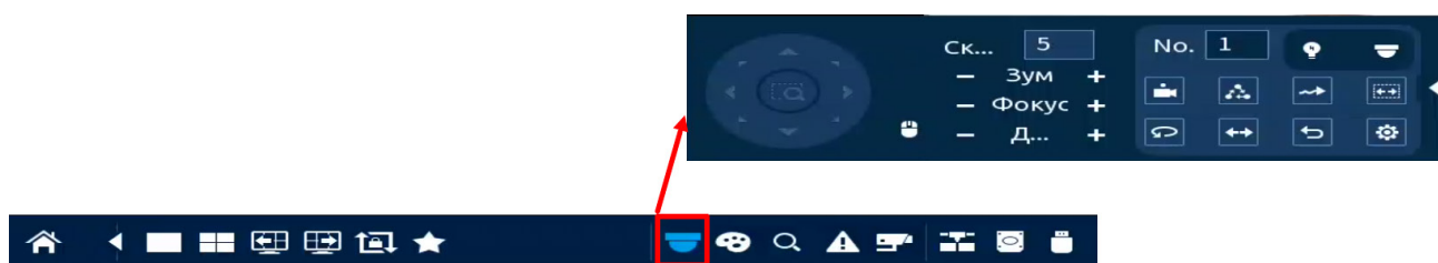
Рисунок 8.1 – Переход в меню PTZ-управления через панель навигации
