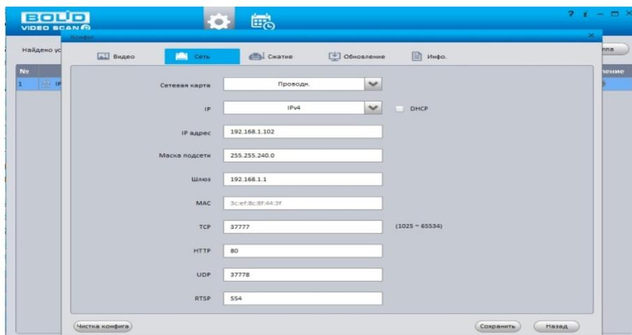
Рисунок 9.2 – Изменение IP-адреса с помощью утилиты «BOLID VideoScan»
