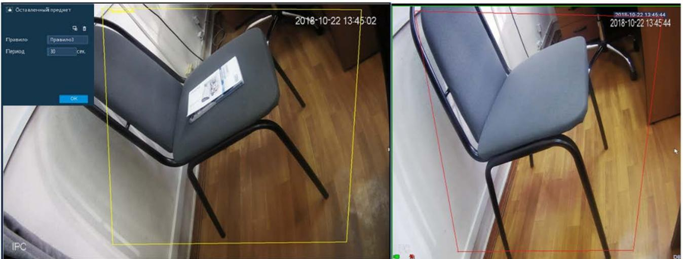
Рисунок 6.36 – «Пропавший предмет» до и после срабатывания
