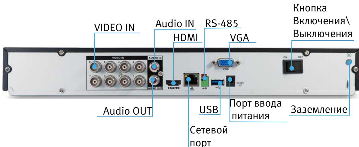
Рисунок 3.2 – Внешний вид задней панели
