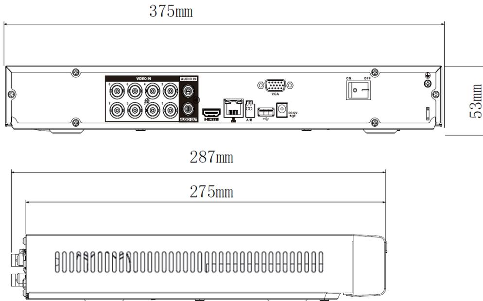
Рисунок 3.9 – Габаритные размеры видеорегистратора
