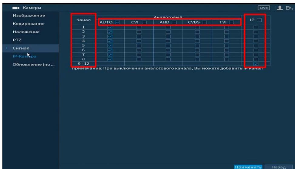
Рисунок 6.62 – Подключение гибридного режима
