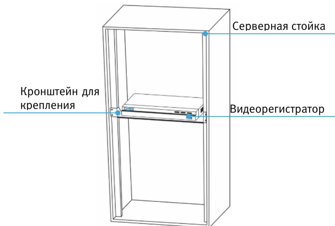
Рисунок 3.12 – Монтаж видеорегистратора в 19”- стойку с помощью кронштейна
