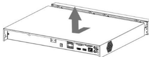
Рисунок 3.4 – Установка жесткого диска
