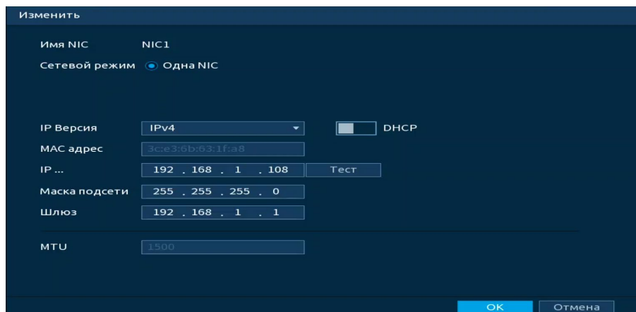
Рисунок 6.6 – Интерфейс меню быстрой настройки «Сеть»
