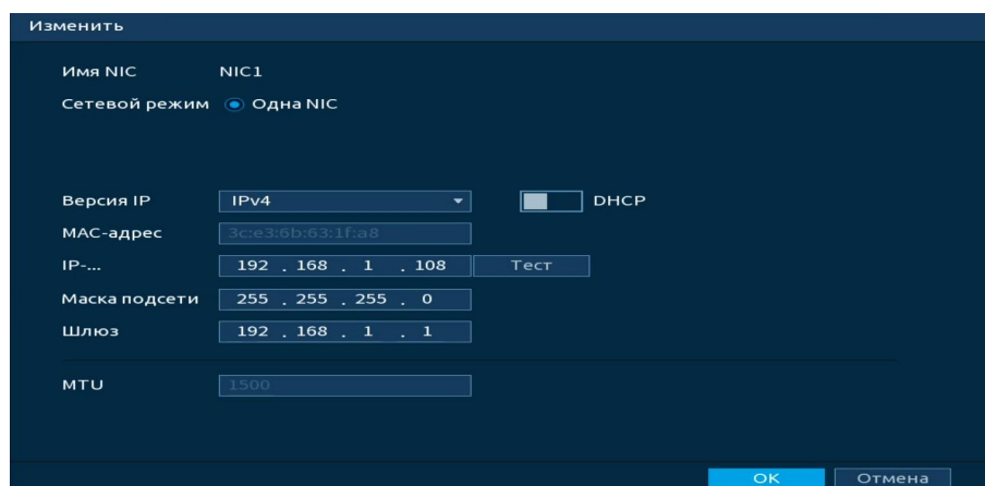
Рисунок 12.2 – Интерфейс настройки «Сеть»
