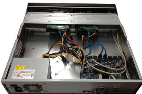
3. Соедините кабель данных жесткого диска с материнской платой и портом жесткого диска в указанном порядке. Ослабьте крепление кабеля питания на корпусе и соедините другой конец кабеля питания с портом жесткого диска.
