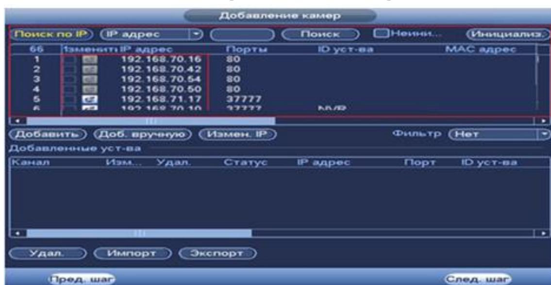
**Рисунок 11 Настройка добавления камер по поиску в сети.**
