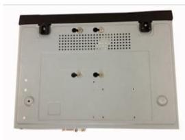
4. Переверните устройство и надежно вкрутите винты в корпус.
