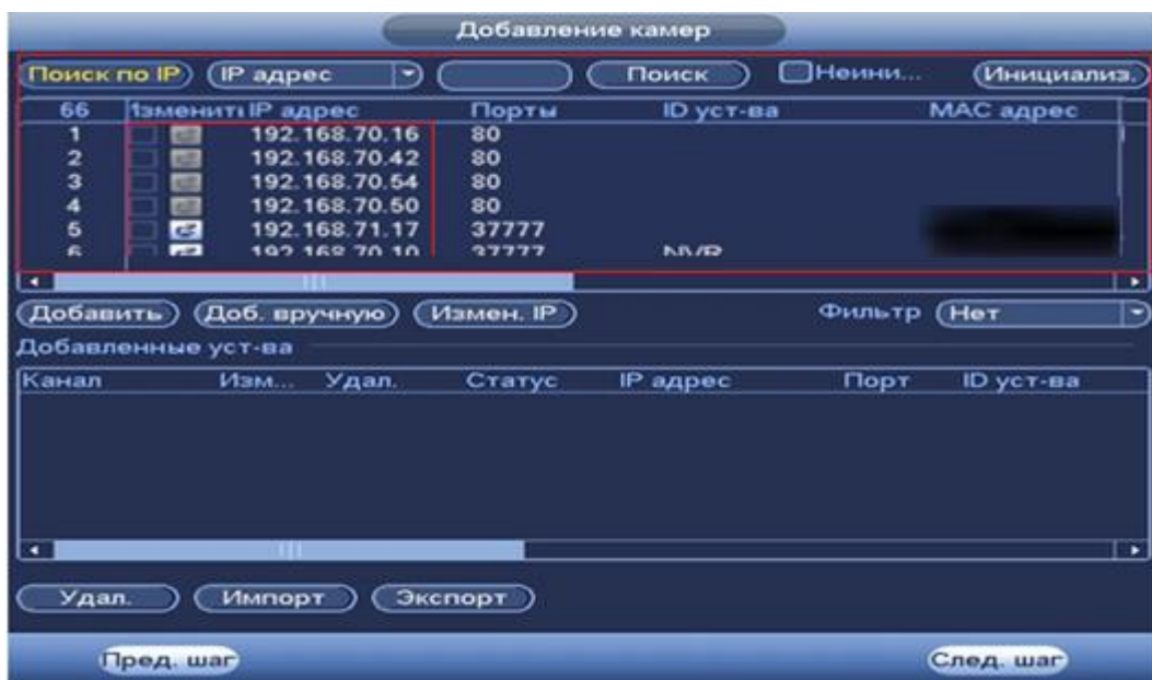
Рисунок 6.10 Настройка добавления камер по поиску в сети.
