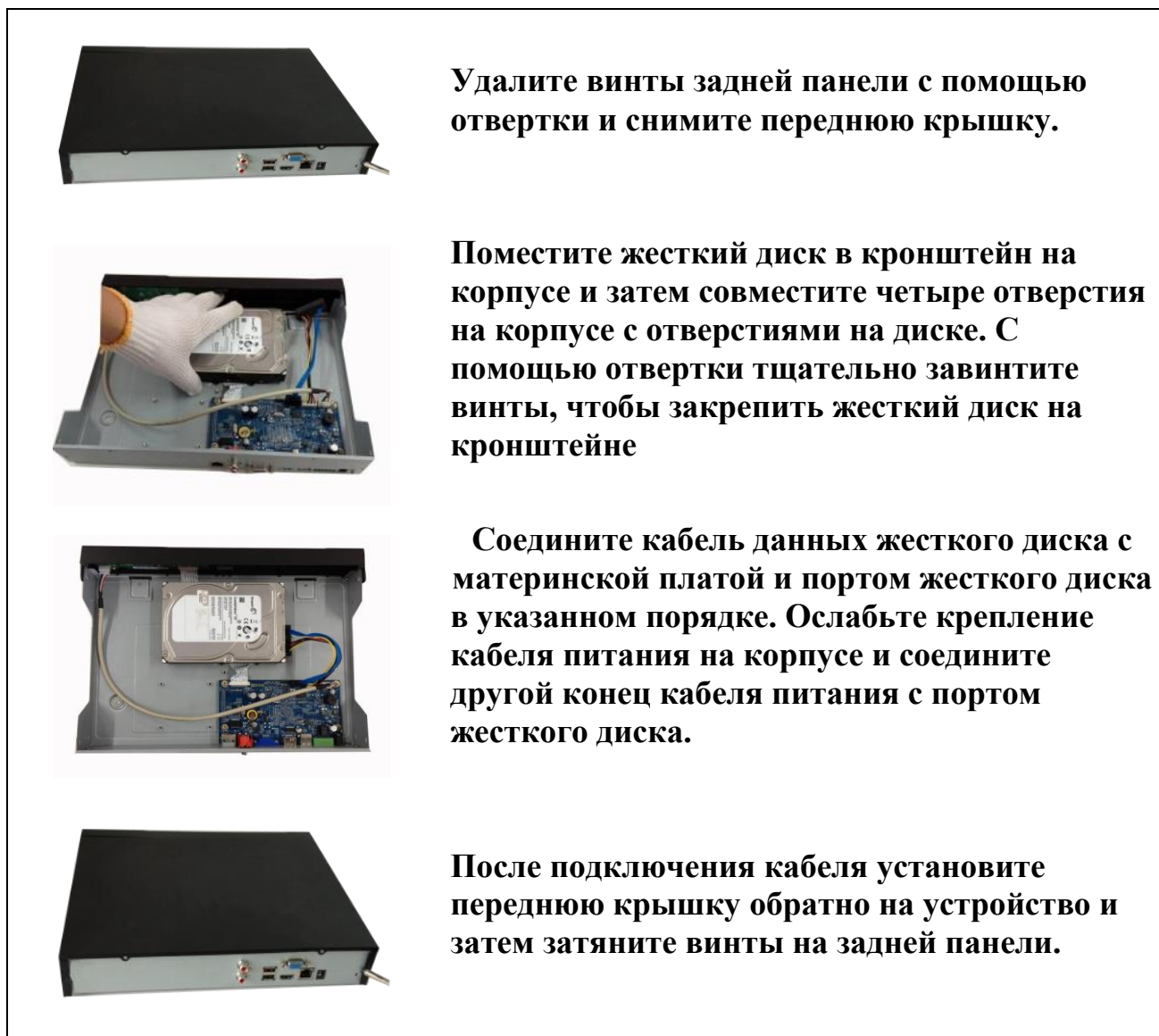
Рисунок 5.1 Установка жесткого диска
