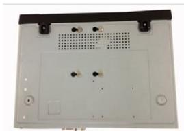
4. Проверните устройство и надежно вкрутите винты в корпус.
