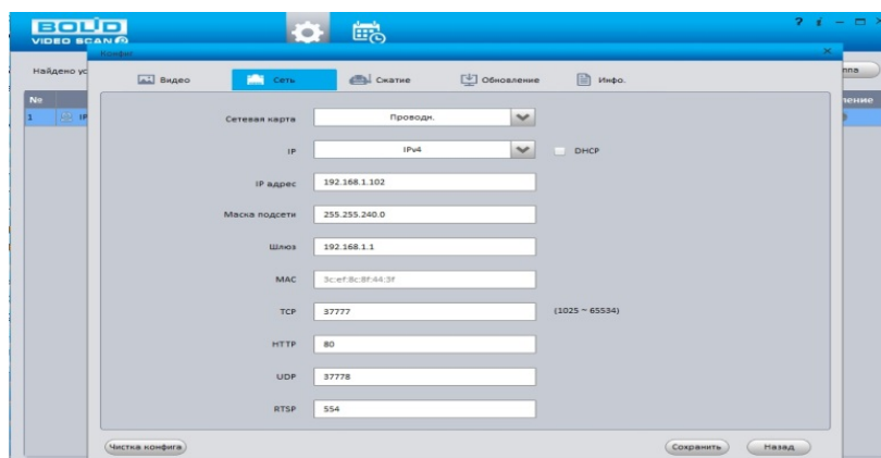
Рисунок 28.2 – Изменение IP-адреса с помощью утилиты «BOLID VideoScan»
