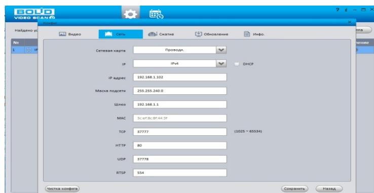
Рисунок 30.2 – Изменение IP-адреса с помощью утилиты «BOLID VideoScan»
