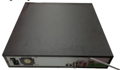
1. Удалите винты задней панели с помощью отвертки и снимите
