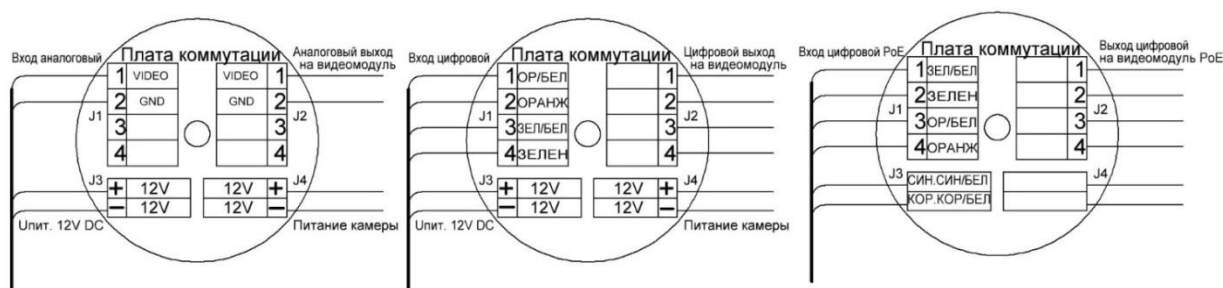
Рисунок 4.3 – Схема подключения термокожуха
