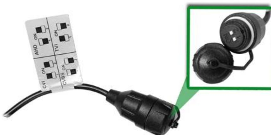
Рисунок 6.3 – Переключатель формата видеосигнала
