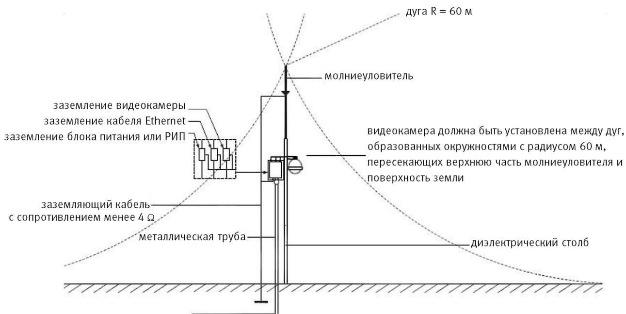
Рисунок 6.6 – Установка молниеотвода
