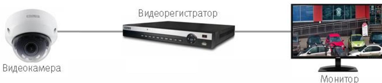
Рисунок 6.2 – Схема подключения видеокамеры
