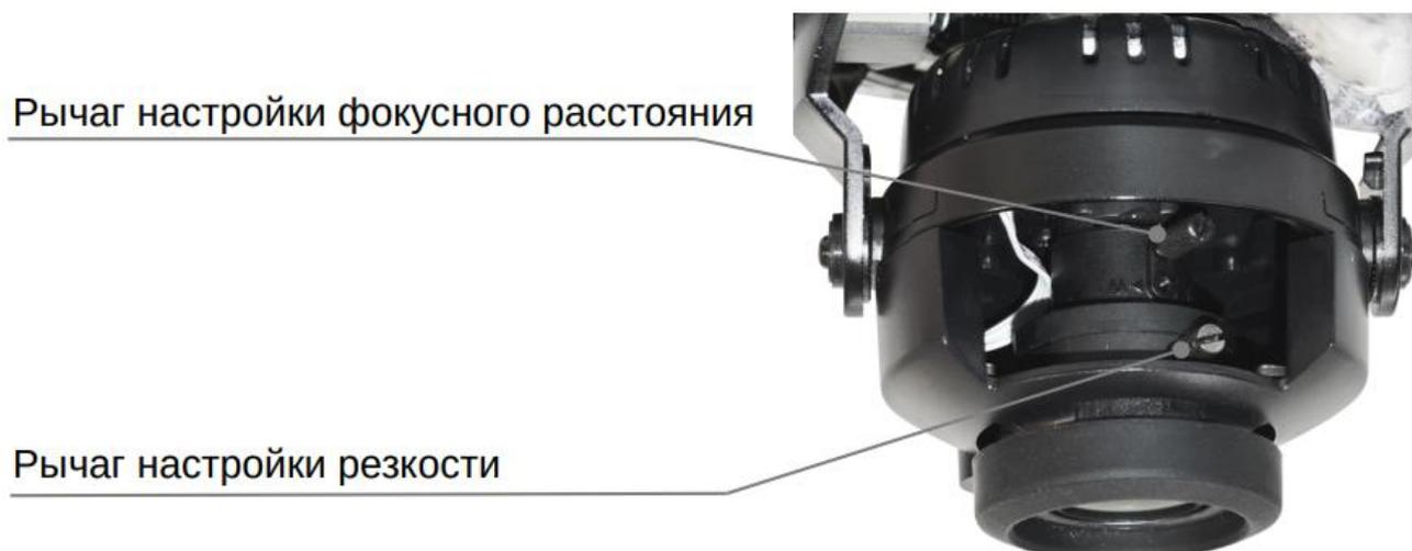
Рисунок 6.4 – Настройка фокусного расстояния и резкости
