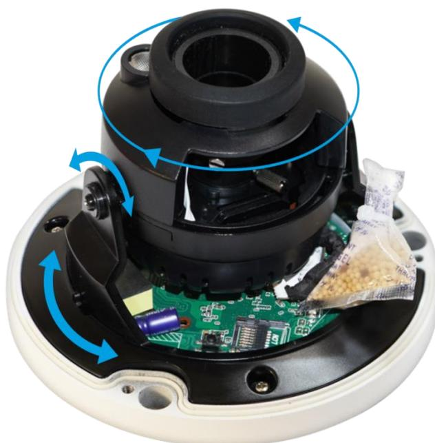
Рисунок 6.5 – Настройка направления объектива
