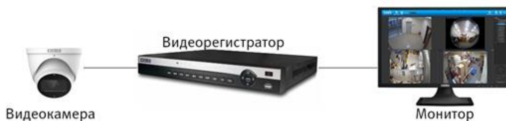
Рисунок 6.2 – Схема подключения видеокамеры
