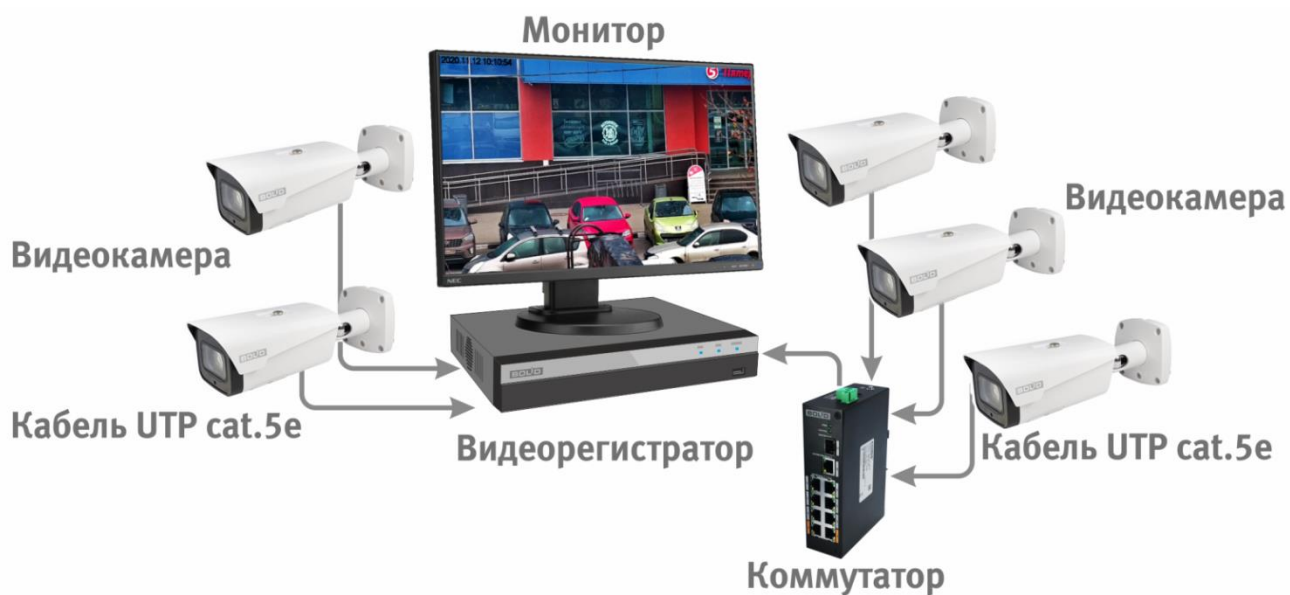
Рисунок 6.5 – Схема подключения видеокамеры к видеорегистратору
