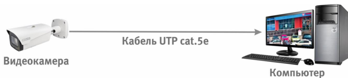
Рисунок 6.3 – Схема подключения видеокамеры к компьютеру
