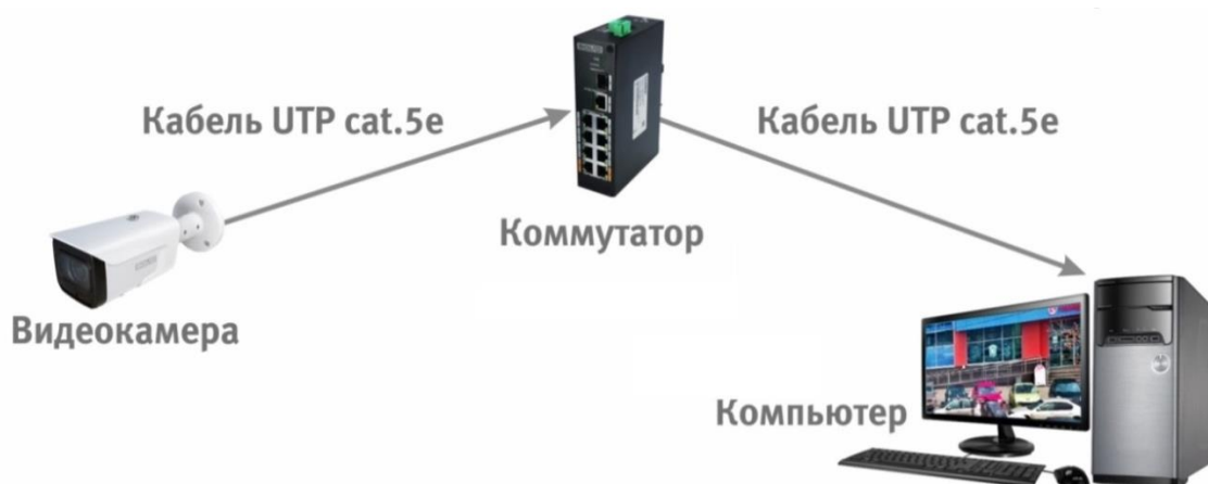
Рисунок 6.3 – Схема подключения видеокамеры к компьютеру через коммутатор
