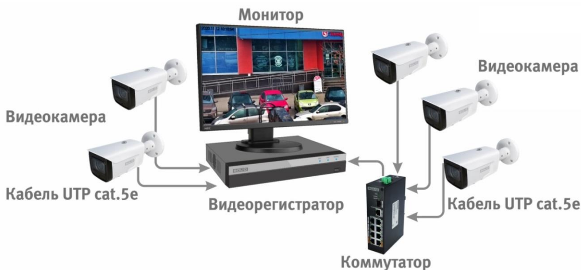
Рисунок 6.4 – Схема подключения видеокamеры к видеорегистратору
