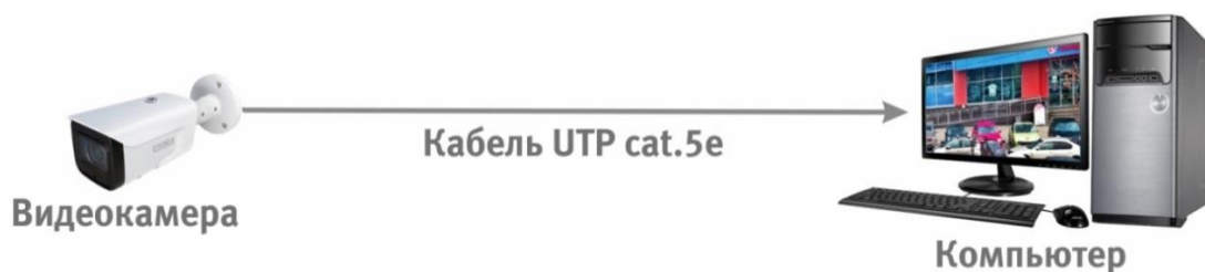
Рисунок 6.2 – Схема подключения видеокамеры к компьютеру
