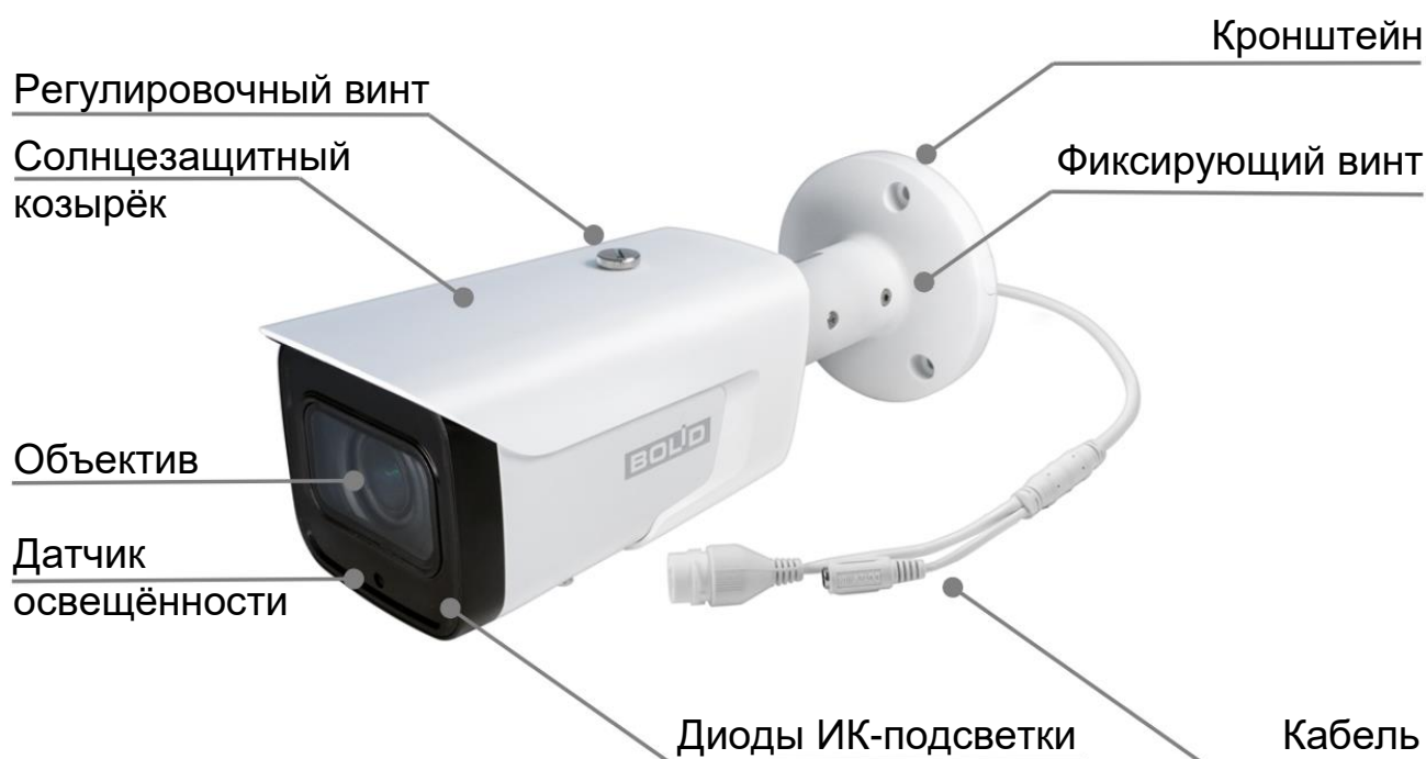
Рисунок 4.1 – Внешний вид и основные элементы видеокамеры
