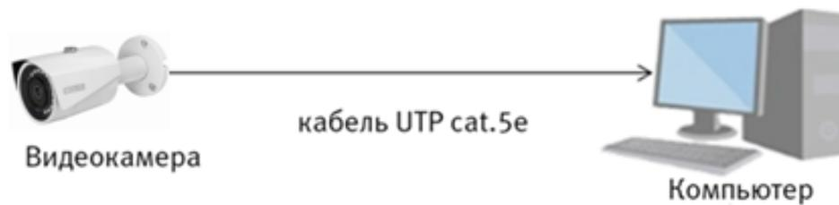
Рисунок 6.2 – Схема подключения видеокамеры к компьютеру
