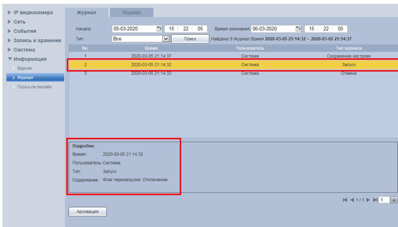
Рисунок 7.121 – Просмотр подробной информации о системном событии
