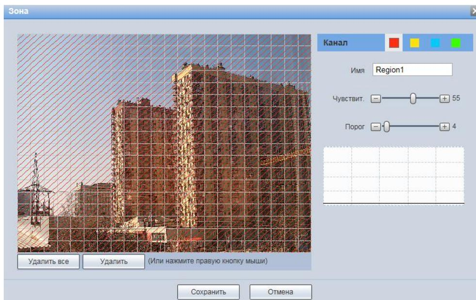
Рисунок 7.72 – Вкладка «Обнаружение движения»: Область
