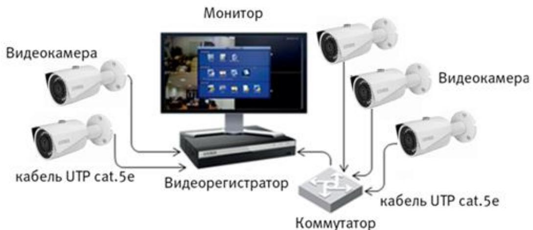
Рисунок 6.4 – Схема подключения видеокамеры к видеорегистратору
