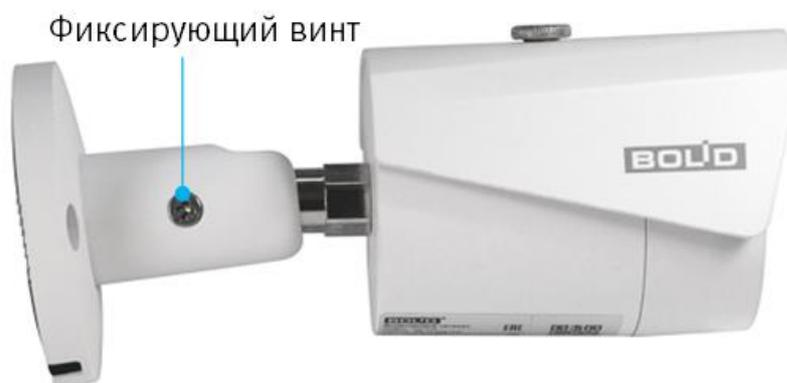
Рисунок 5.14 - Настройка направления объектива
