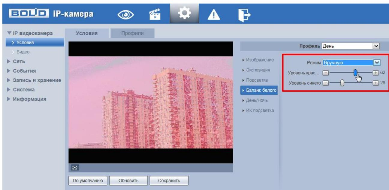
Рисунок 7.33 – Настройка режима баланса белого «Вручную»
