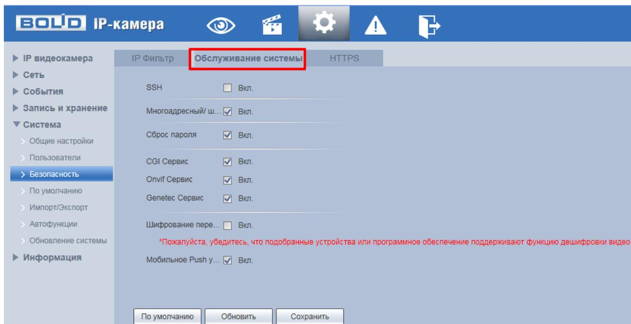
Рисунок 7.110 - Вкладка «Обслуживание системы»
