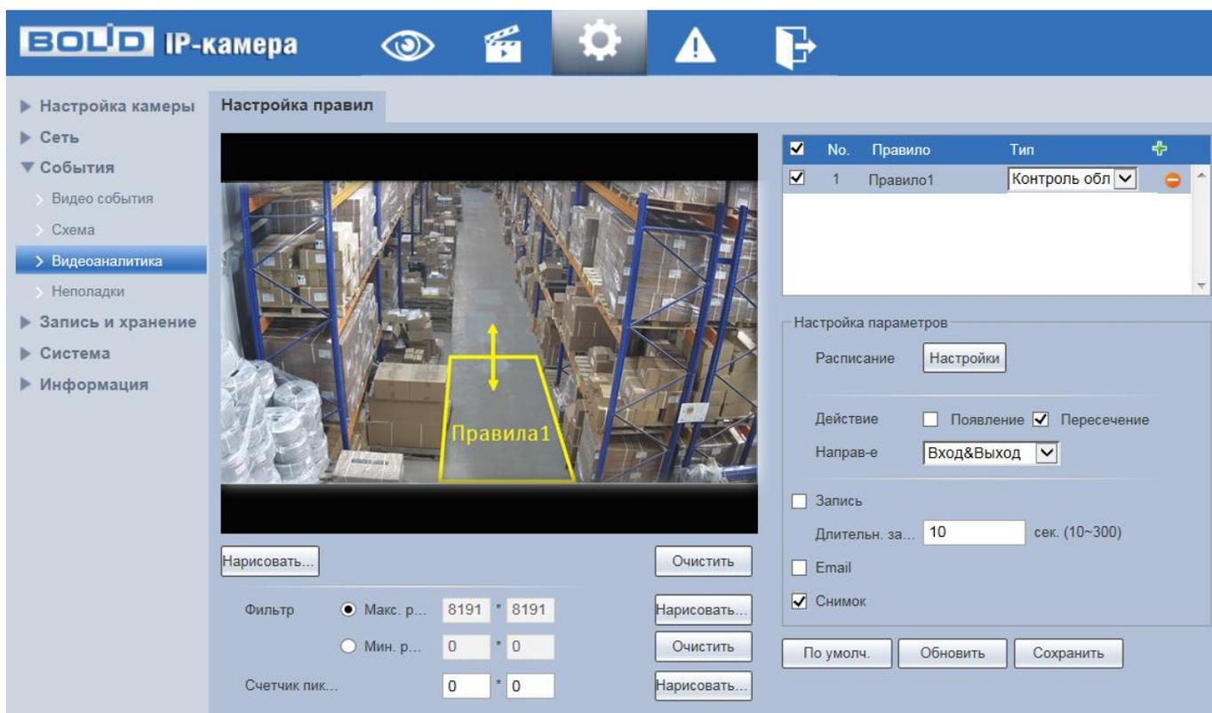
Рисунок 7.77 — Создание правила видеоаналитики «Контроль области»
