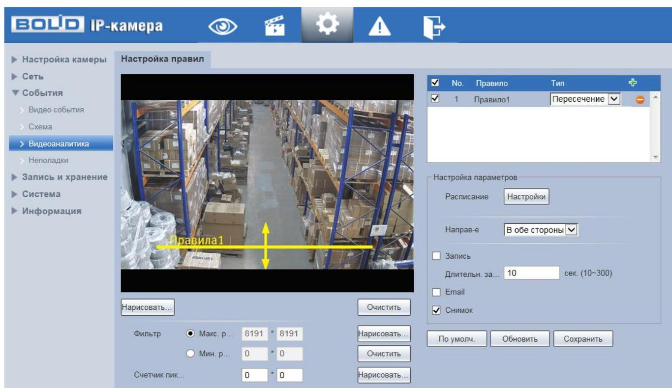
Рисунок 7.76 — Создание правила видеоаналитики «Пересечение линии»
