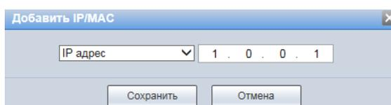
Рисунок 7.110 — Вкладка «Брандмауэр»: Добавление IP/MAC адреса
