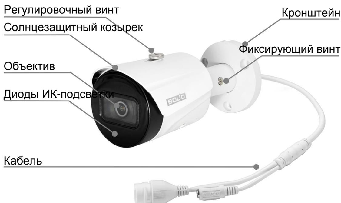
Рисунок 4.1 — Внешний вид и основные элементы видеокамеры
