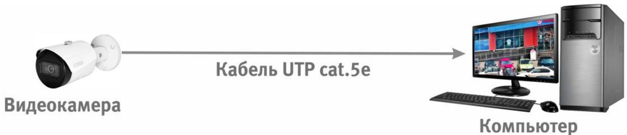
Рисунок 6.2 — Схема подключения видеокамеры к компьютеру
