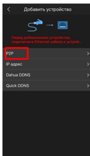
Рисунок 9.6 — Добавление устройства по P2P в мобильном приложении
