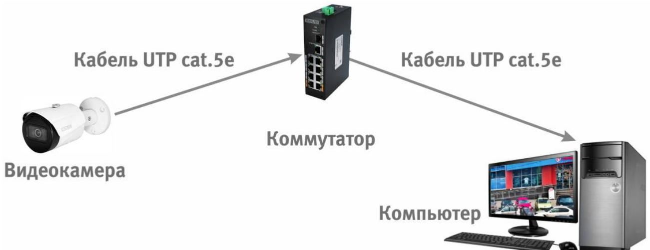
Рисунок 6.3 — Схема подключения видеокамеры к компьютеру через коммутатор
