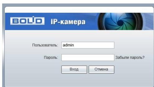
Рисунок 7.5 — Вход в web-интерфейс видеочамеры
