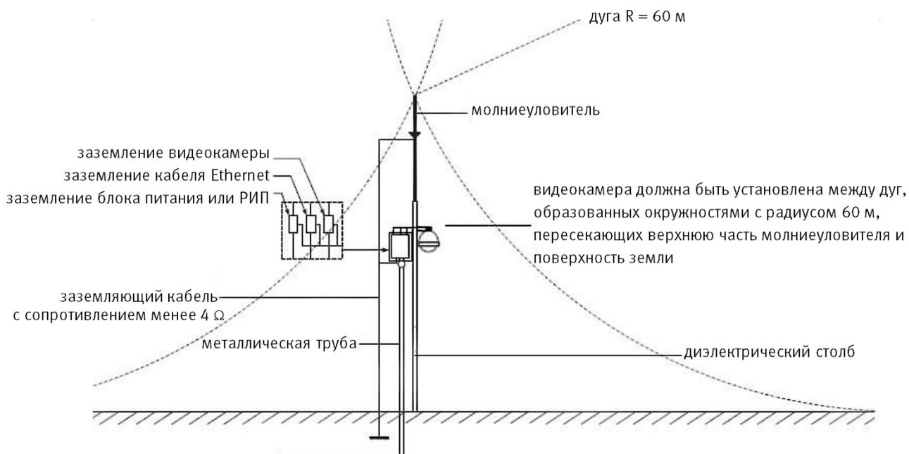
Рисунок 6.12 – Установка молниеотвода
