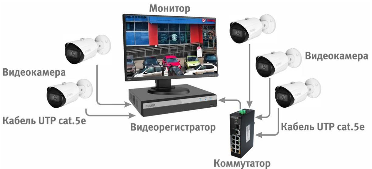
Рисунок 6.4 – Схема подключения видеокamеры к видеорегистратору
