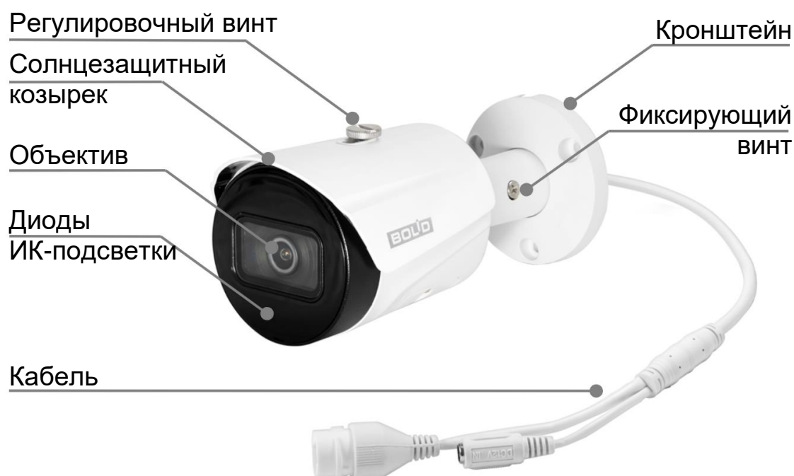
Рисунок 4.1 – Внешний вид и основные элементы видеокамеры
