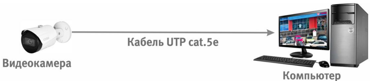
Рисунок 6.2 – Схема подключения видеокамеры к компьютеру
