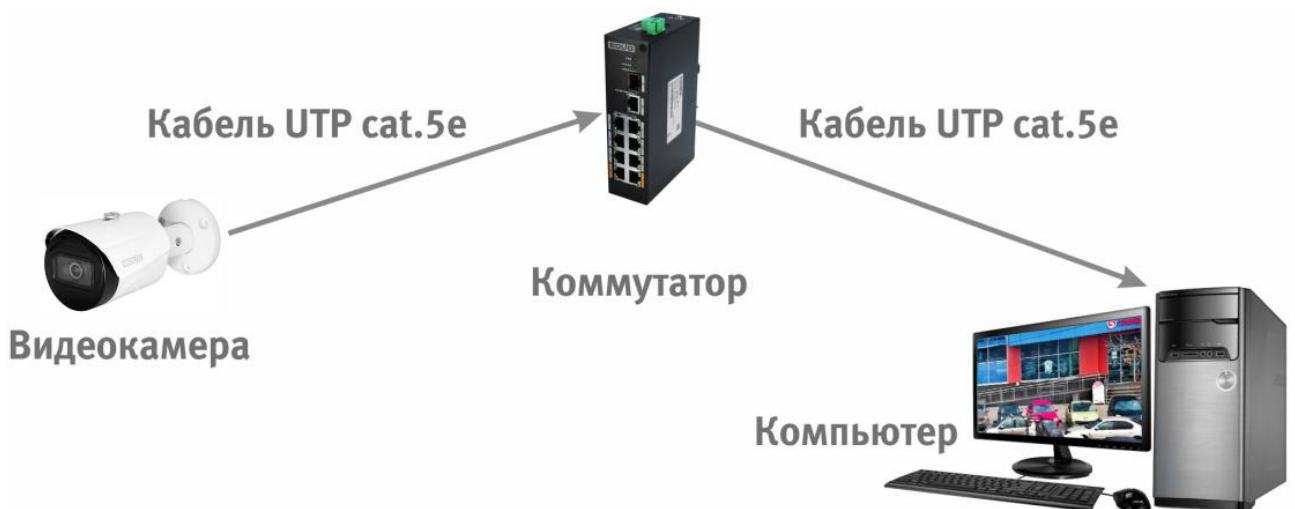
Рисунок 6.3 – Схема подключения видеокамеры к компьютеру через коммутатор
