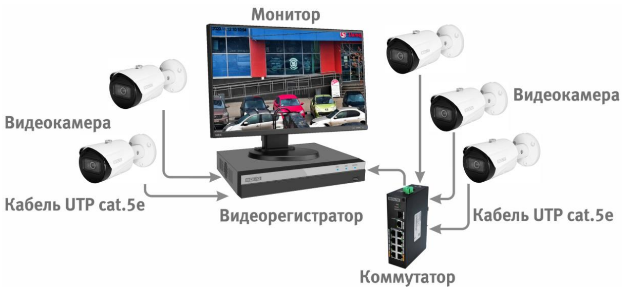
Рисунок 6.4 – Схема подключения видеокamеры к видеорегистратору
