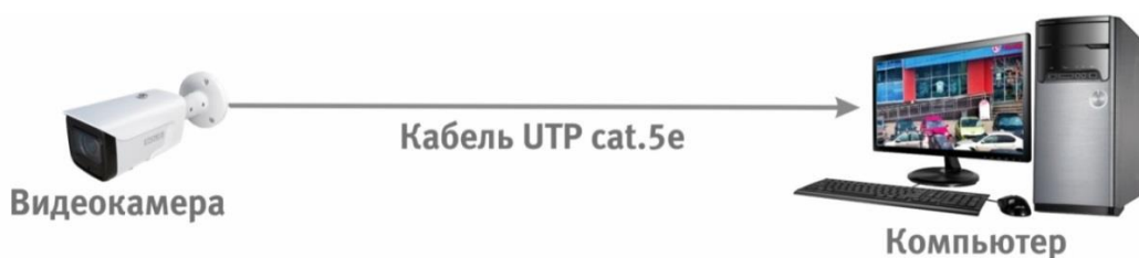
Рисунок 6.2 – Схема подключения видеокамеры к компьютеру
