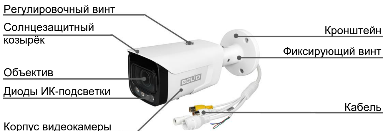
Рисунок 4.1 – Внешний вид и основные элементы видеокамеры
