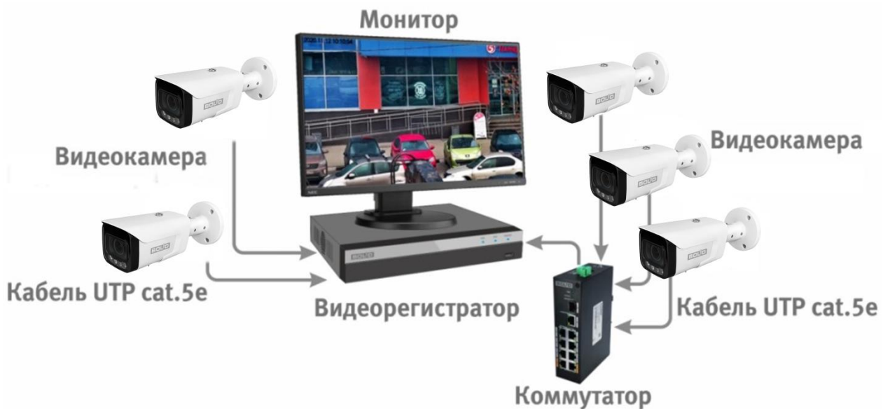
Рисунок 6.4 – Схема подключения видеокамеры к видеорегистратору
