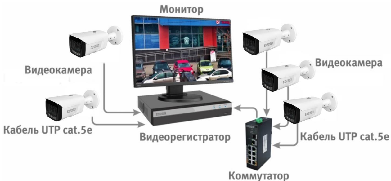
Рисунок 6.4 – Схема подключения видеокамеры к видеорегистратору
