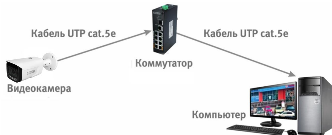
Рисунок 6.3 – Схема подключения видеокамеры к компьютеру через коммутатор
