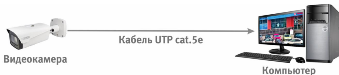
Рисунок 6.3 – Схема подключения видеокамеры к компьютеру
