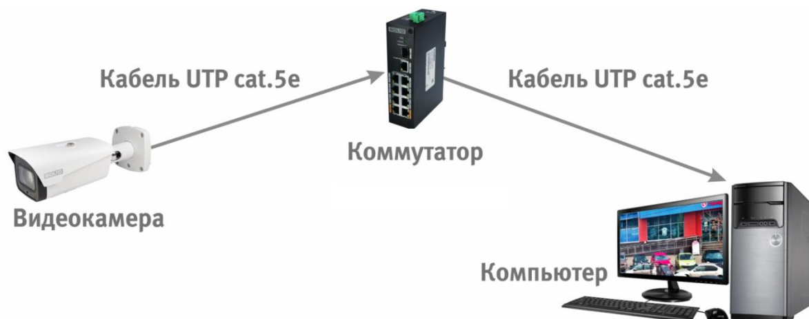
Рисунок 6.4 – Схема подключения видеокамеры к компьютеру через коммутатор
