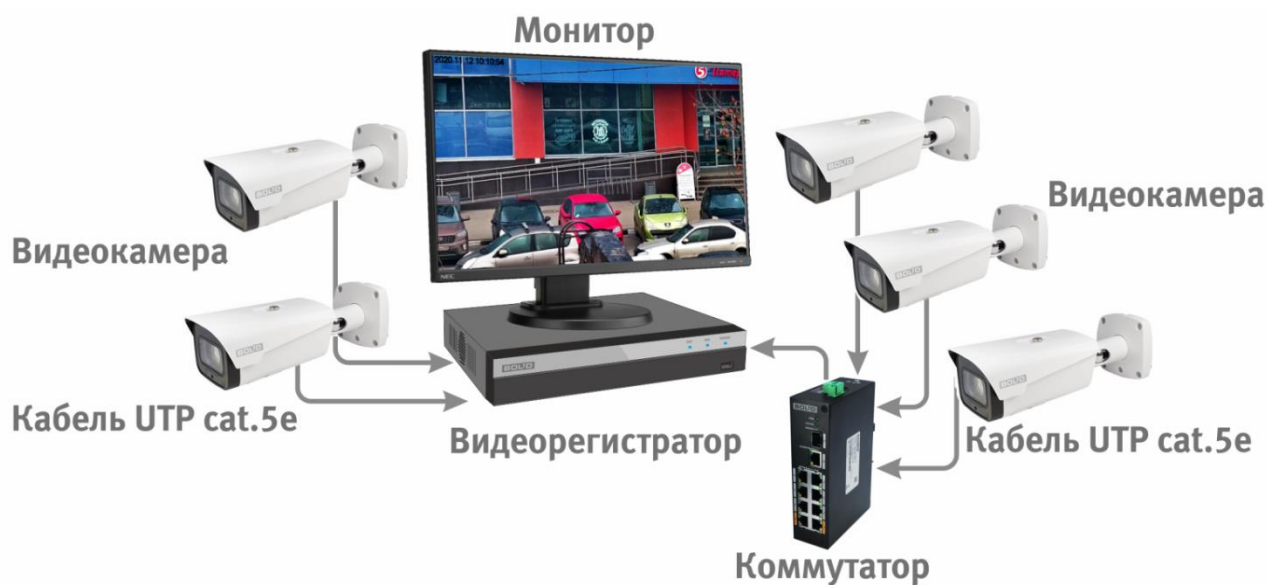
Рисунок 6.5 – Схема подключения видеокамеры к видеорегистратору
