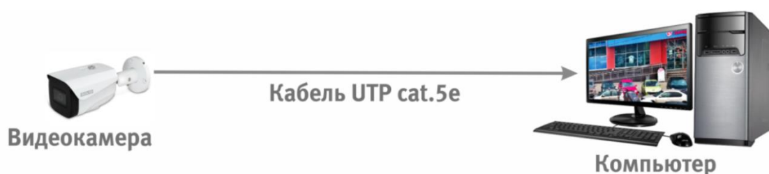
Рисунок 6.2 – Схема подключения видеокмеры к компьютеру
