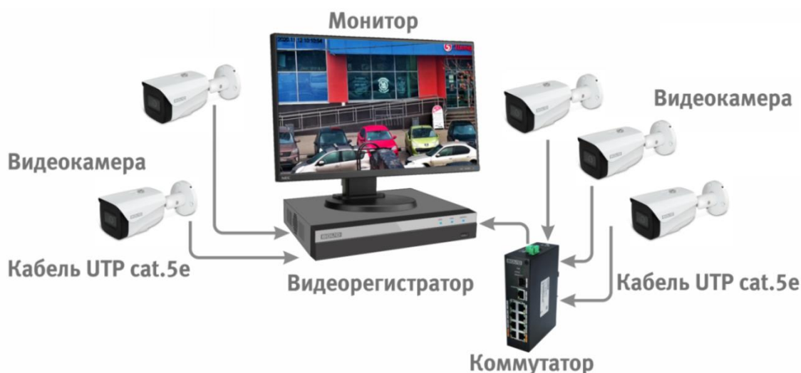
Рисунок 6.4 – Схема подключения видеокмеры к видеорегистратору
