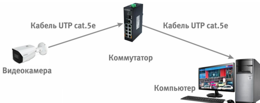
Рисунок 6.3 – Схема подключения видеокмеры к компьютеру через коммутатор
