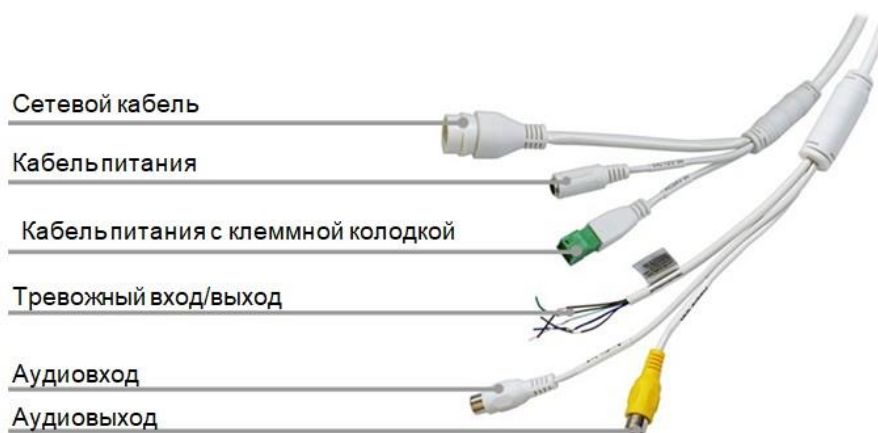
Рисунок 6.1 – Кабель видеокamеры
