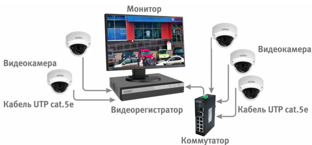
Рисунок 6.4 – Схема подключения видеокамеры к видеорегистратору
