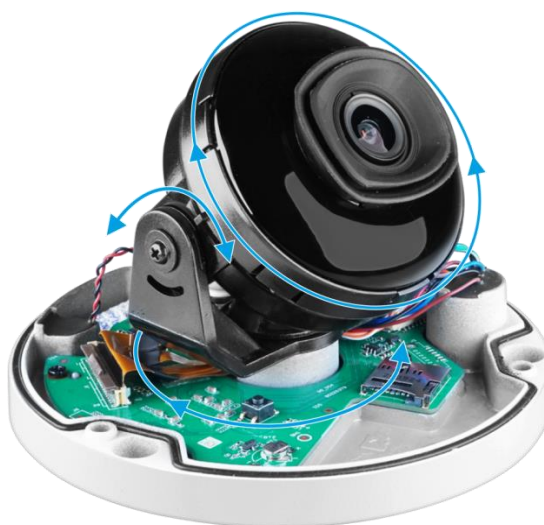
Рисунок 5.11 – Настройка направления объектива
