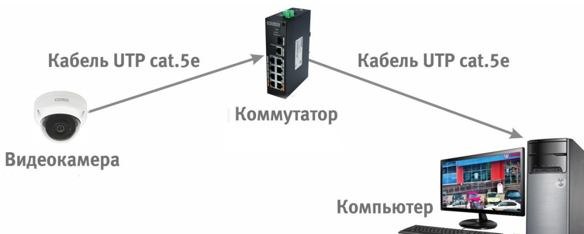
Рисунок 6.3 – Схема подключения видеокамеры к компьютеру через коммутатор
