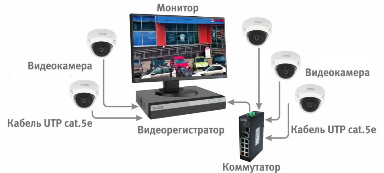
Рисунок 6.4 – Схема подключения видеокамеры к видеорегистратору
