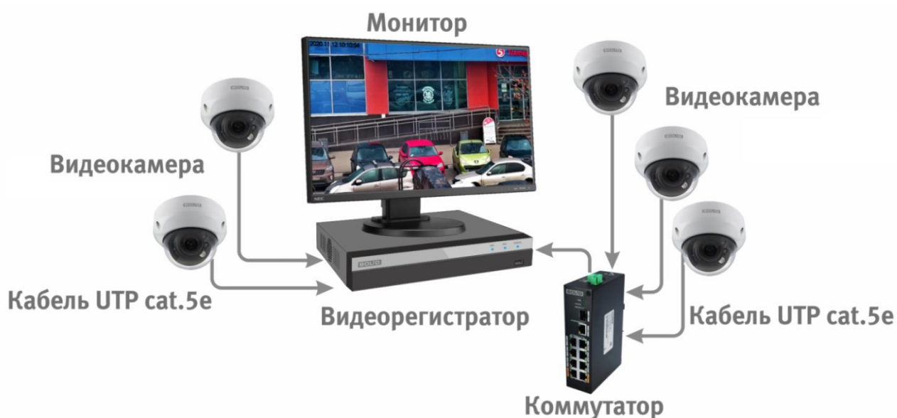
Рисунок 6.4 – Схема подключения видеокamеры к видеорегистратору
