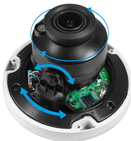
Рисунок 5.12 – Настройка направления объектива
