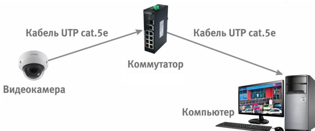
Рисунок 6.3 – Схема подключения видеокамеры к компьютеру через коммутатор
