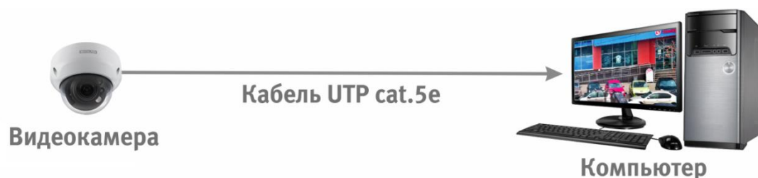
Рисунок 6.2 – Схема подключения видеокамеры к компьютеру
