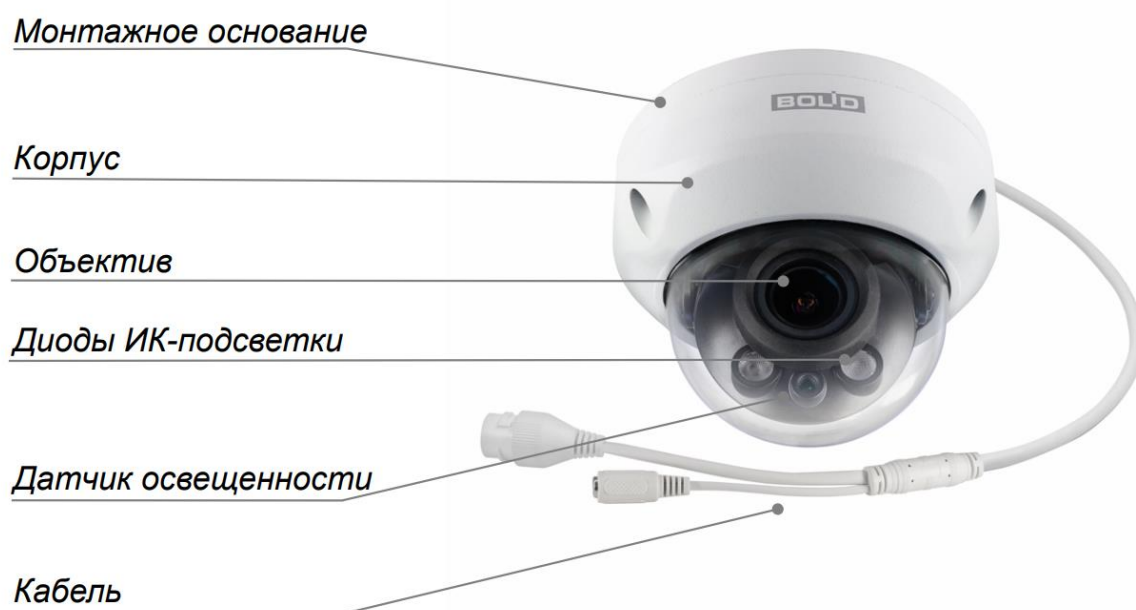
Рисунок 4.1 – Внешний вид и основные элементы видеокамеры
