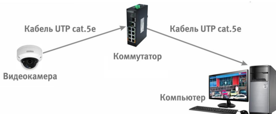
Рисунок 6.3 – Схема подключения видеокамеры к компьютеру через коммутатор
