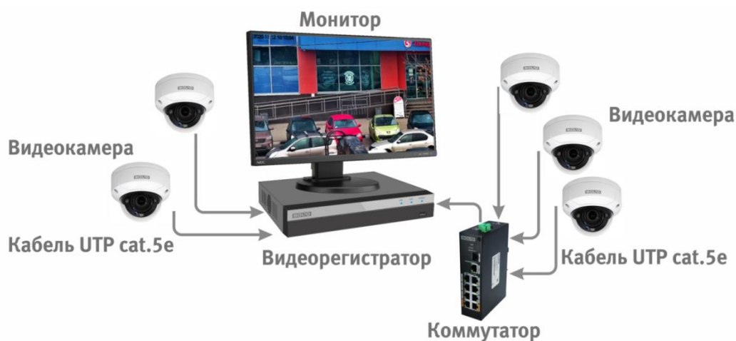
Рисунок 6.4 – Схема подключения видеокамеры к видеорегистратору
