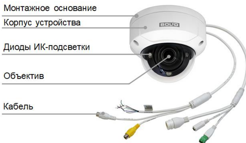
Рисунок 4.1 – Внешний вид и основные элементы видеокамеры
