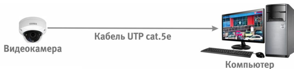
Рисунок 6.2 – Схема подключения видеокамеры к компьютеру
