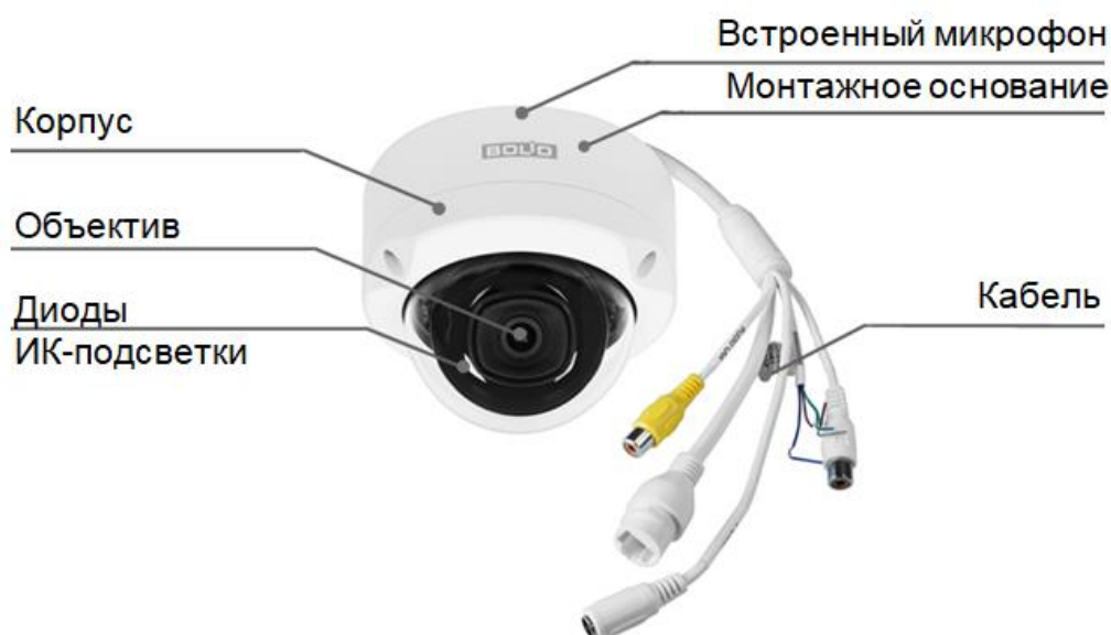
Рисунок 4.1 – Внешний вид и основные элементы видеокамеры
