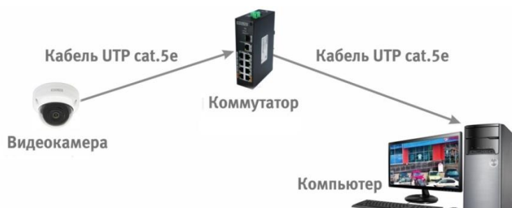
Рисунок 6.3 – Схема подключения видеокамеры к компьютеру через коммутатор
