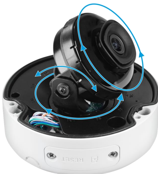
Рисунок 5.7 – Настройка направления объектива
