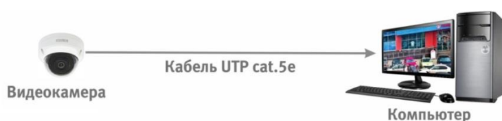
Рисунок 6.2 – Схема подключения видеокамеры к компьютеру
