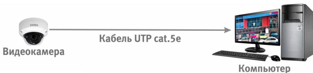
Рисунок 6.3 – Схема подключения видеокamеры к компьютеру
