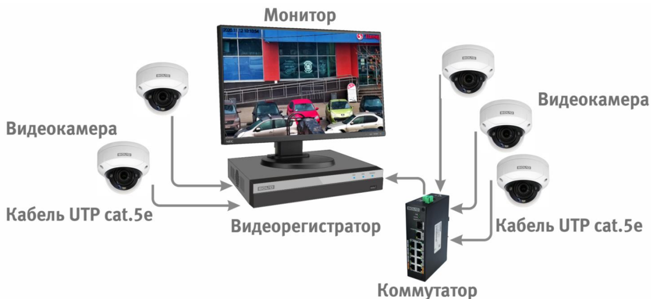
Рисунок 6.5 – Схема подключения видеокamеры к видеорегистратору
