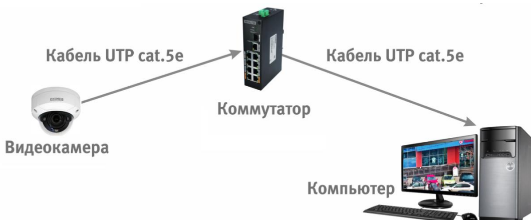
Рисунок 6.4 – Схема подключения видеокamеры к компьютеру через коммутатор
