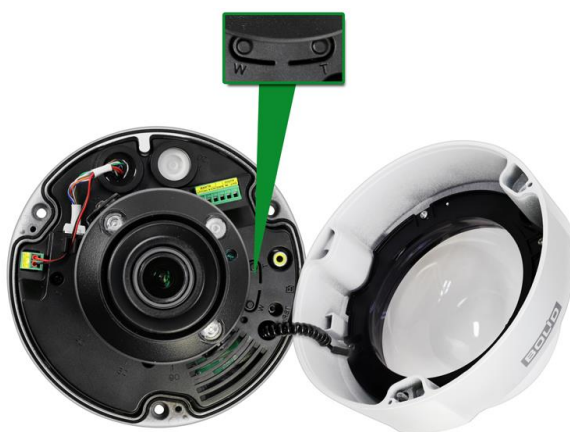
Рисунок 5.15 – Настройка фокусного расстояния вручную
