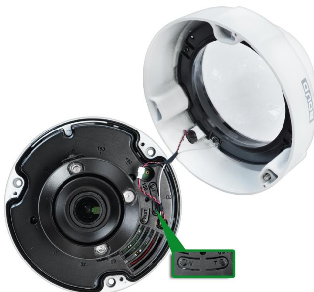
Рисунок 5.19 – Настройка фокусного расстояния вручную
