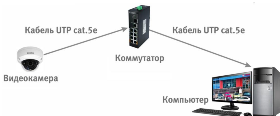
Рисунок 6.3 – Схема подключения видеокамеры к компьютеру через коммутатор
