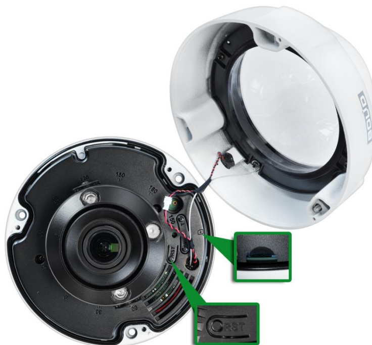
Рисунок 4.2 – Расположение кнопки аппаратного сброса и слота для карты памяти
