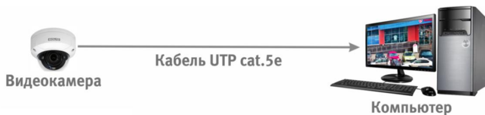
Рисунок 6.2 – Схема подключения видеокамеры к компьютеру
