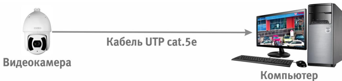
Рисунок 6.2 – Схема подключения видеокамеры к компьютеру
