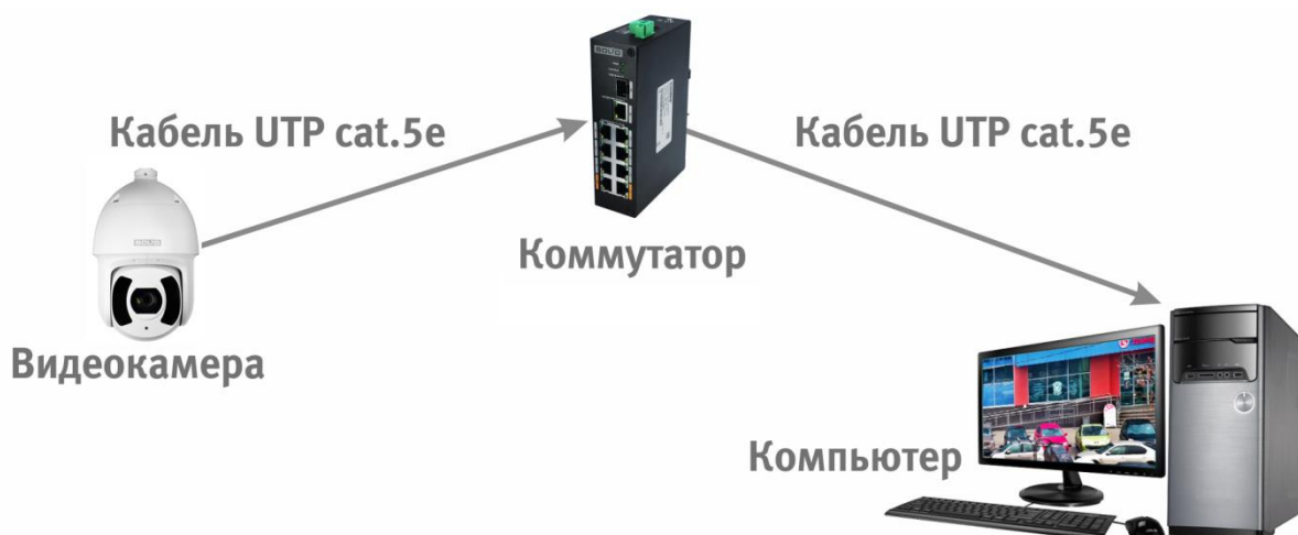
Рисунок 6.3 – Схема подключения видеокамеры к компьютеру через коммутатор
