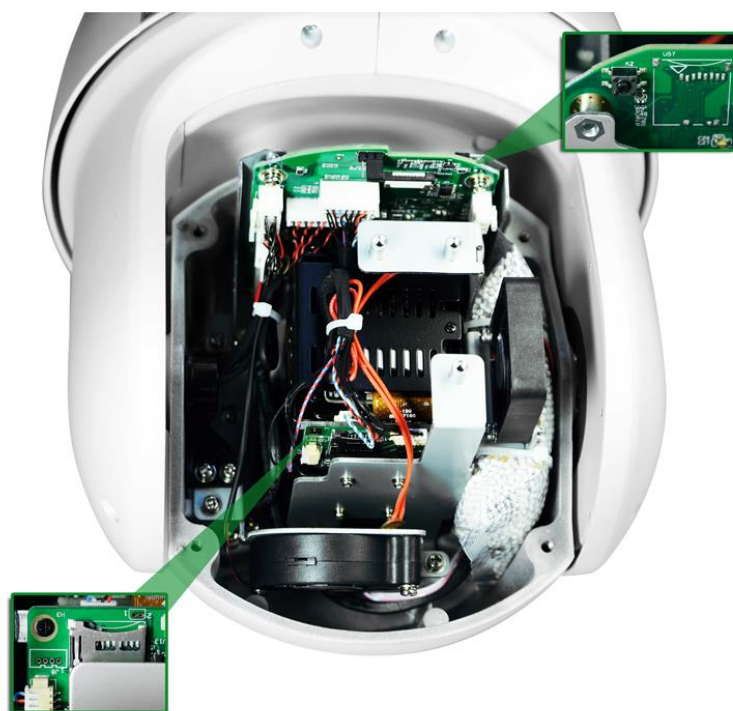
Рисунок 4.2 – Расположение слота для карты памяти и кнопки аппаратного сброса
