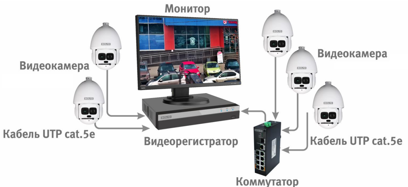
Рисунок 6.4 – Схема подключения видеокамеры к видеорегистратору
