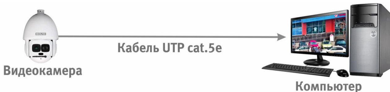
Рисунок 6.2 – Схема подключения видеокамеры к компьютеру
